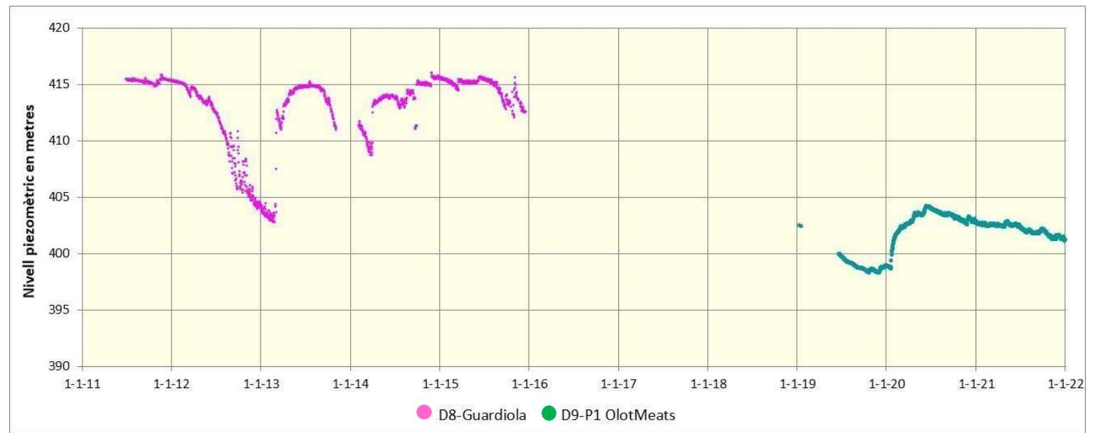
Fig. 5.5.- Comparació dels nivells piezomètrics a escala diària, dels punts dels limnígrafs D-8 (Guardiola) i D-9 (P1 Olot-Meats) de l'aqüífer fluviovolcànic del Pla d'Olot, en el període 2011 al 2021.
