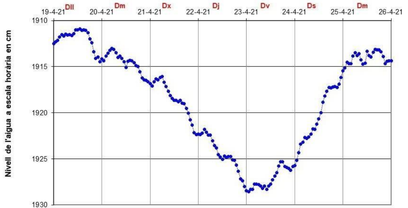
Fig. 4.21.- Variació dels nivells mesurats a escala horària en el limnigraf D-9, P-1 Olot-Meats, a la setmana del 19 al 25 d’abril de 2021.
