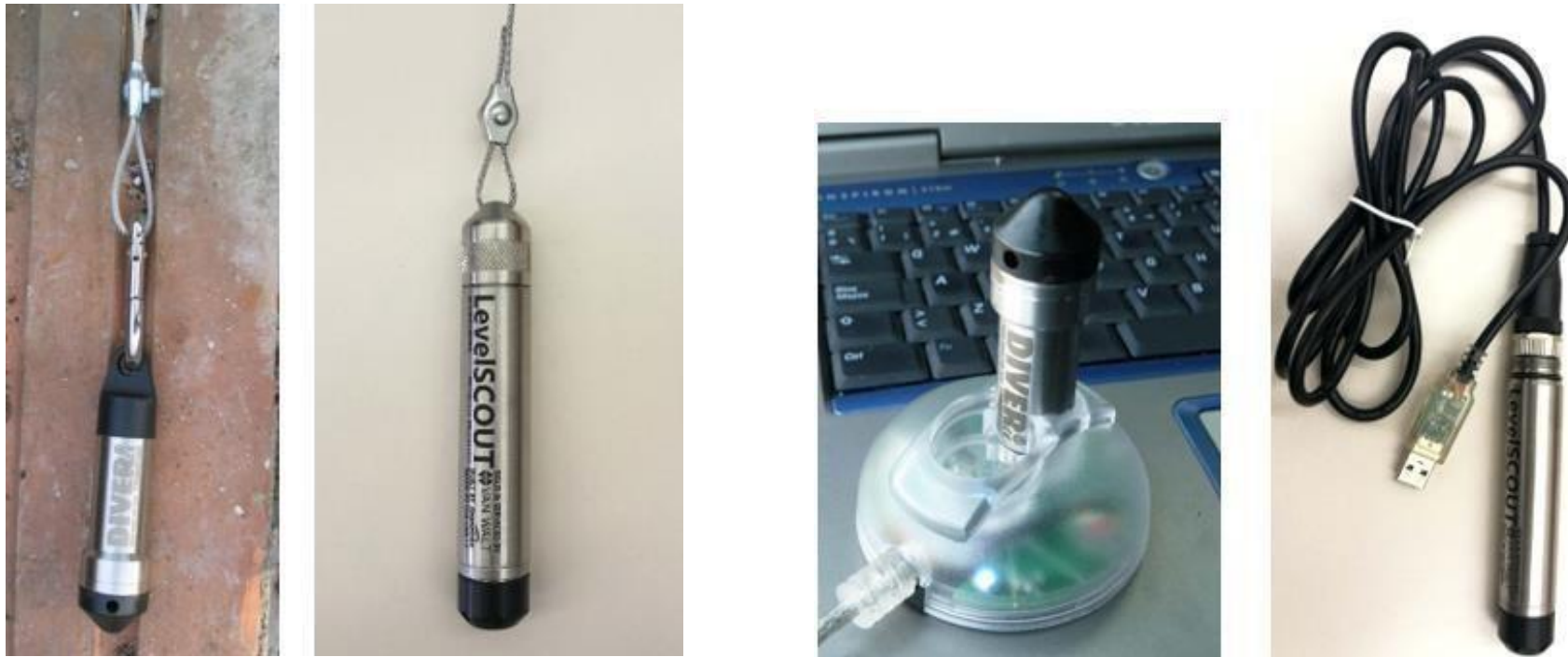
Fig. 2.2. A la part esquerra, imatges de les sondes MiniDiver (a l'esquerra) i LevelScout (a la dreta), amb el fil d'acer de subjecció. A la part dreta, imatges dels lectors, la sonda MiniDIVER dins del lector òptic (a l'esquerra) i el sensor levelScout amb el seu connector USB (a la dreta).
