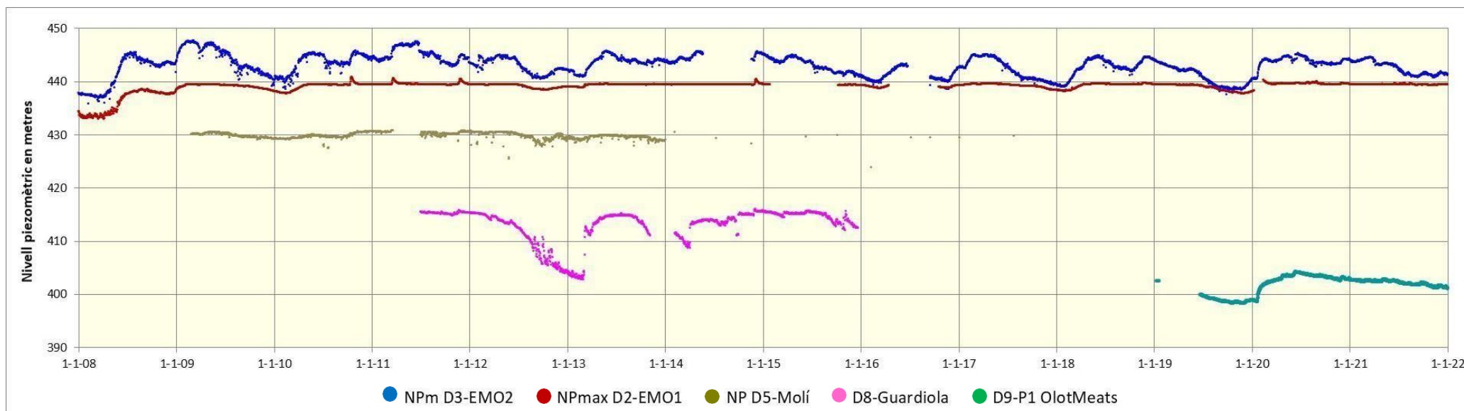
Fig. 5.6.- Comparació dels nivells piezomètrics a escala diària, dels punts dels limnífgrafs D-2, D-3, D-5, D-8 i D-9 de l'aqüífer fluvivolcànic del Pla d'Olot, en el període 2008 al 2021.
