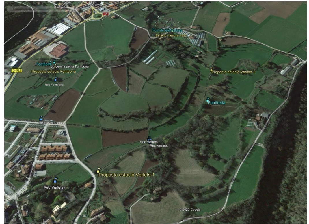
Fig. 7.2.- Situació dels punts d'aforament de la xarxa de fonts i recs de la zona de Verlets i Fontbona. En blau clar les fonts, en blau marí els recs i en groc els punts de mesura i les propostes de futur.
