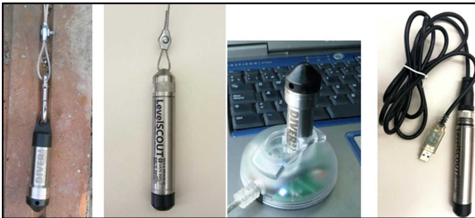
Fig. 2. 2. A la part esquerra, imatges de les sondes MiniDiver (a l'esquerra) i LevelScout (a la dreta), amb el fil d'acer de subjecció. A la part dreta, imatges dels lectors, la sonda MiniDIVER dins del lector òptic (a l'esquerra) i el sensor levelScout amb el seu connector USB (a la dreta).
