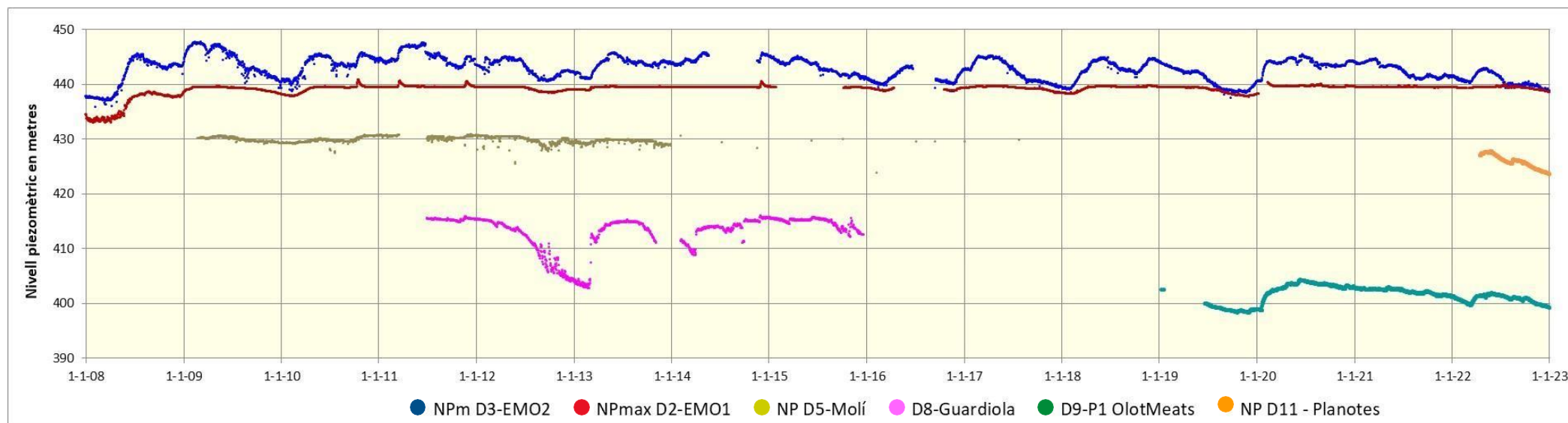
Fig. 5. 6. Comparació dels nivells piezomètrics a escala diària, dels punts dels limnífgrafs D-2, D-3, D-5, D-8, D-9 i D-11 de l'aqüífer fluviovolcànic del Pla d'Olot, en el període 2008 al 2022.
