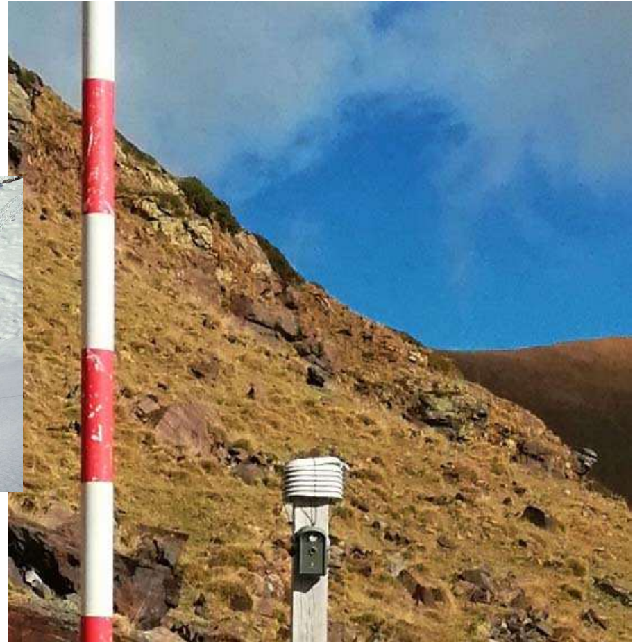
Sensor, càmera i pal de neu, al Triader (2220 m)
